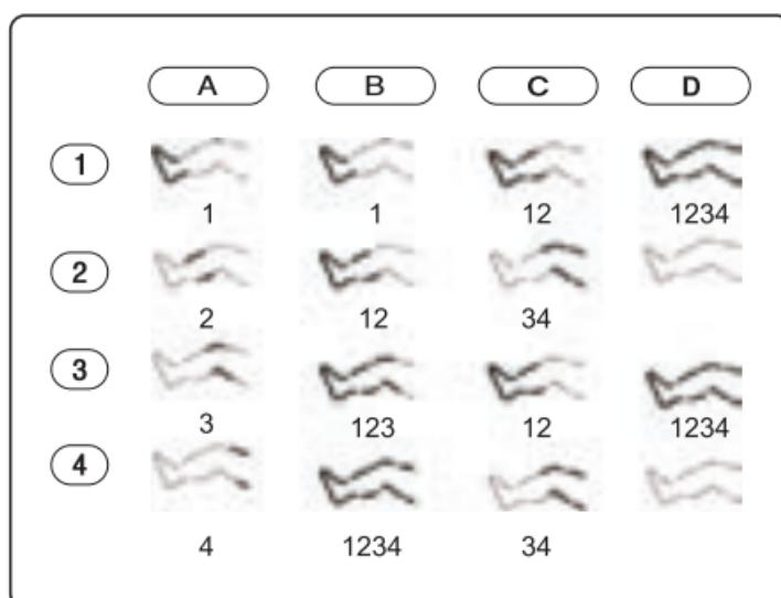
Cihaz açıldıkten sonra AÇMA/KAPATMA tuşuna tekrar basıldığında masaj alanları (1-2-3-4) değişir. Modları (A-B-C-D) değiştirmek için MODE düğmesini kullanın. Modların bağlantı şeması ve çalışma prensibi yukarıdaki resimde gösterilmektedir. TIMER butonunu kullanarak sensörü serbestçe ayarlayabiliriz, bu süre sonunda cihaz otomatik olarak kapanacaktır. YOĞUNLUK düğmesi masajın gücünü ve yoğunluğunu değiştirir.
