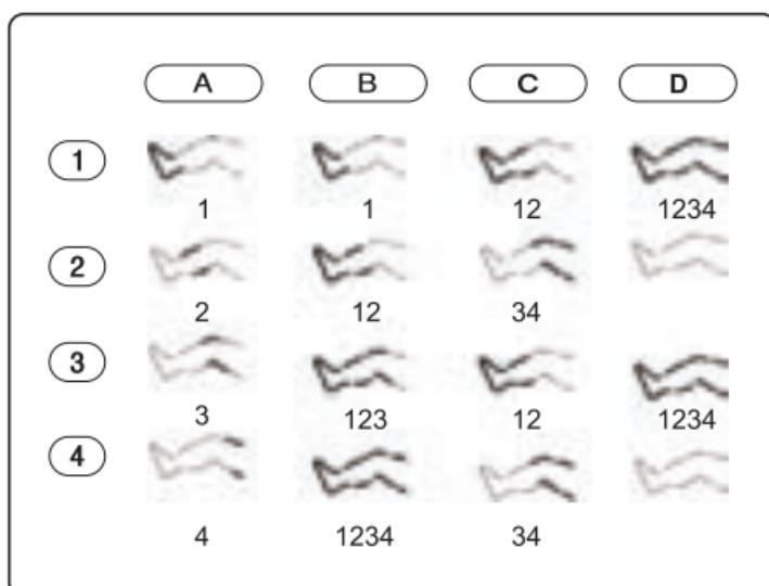
Po spuštění přístroje se opakováním stisknutím tlačítka ON/OFF změní masážní oblasti (1-2-3-4). Pro změnu režimů použijte tlačítko MODE (A-B-C-D). Schéma zapojení režimů a princip jejich činnosti je znázorněn na obrázku výše. Pomocí tlačítka TIMER můžeme libovolně nastavit čidlo, po jaké době se zařízení automaticky vypne. Tlačítko INTENSITY postupně mění sílu a intenzitu masáže.
