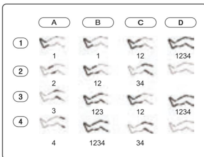
Na het inschakelen van het apparaat kunt u door nogmaals op de AAN/UIT-knop te drukken de massagegebieden wijzigen (1-2-3-4). Gebruik de MODE-knop om de modus te wijzigen (A-B-C-D). Het aansluitschema van de modi en het principe van hun werking worden weergegeven in de bovenstaande afbeelding. Met behulp van de TIMER-knop kunnen we de sensor vrij instellen, waarna het apparaat automatisch wordt uitgeschakeld. Met de INTENSITY-knop wijzigt u de kracht en intensiteit van de massage.
