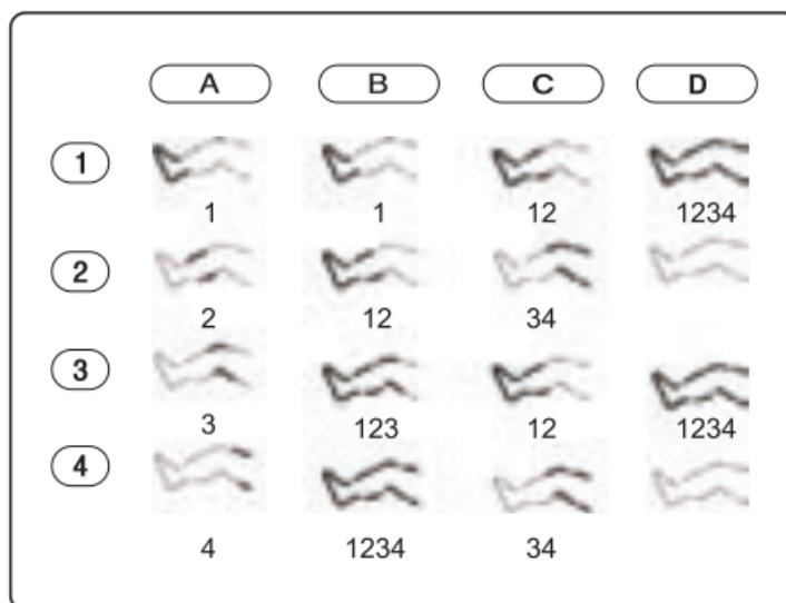
После запуска аппарата повторное нажатие кнопки ВКЛ/ВЫКЛ меняет зоны массажа (1-2-3-4). Используйте кнопку MODE для изменения режимов (A-B-C-D). Схема подключения режимов и принцип их работы показаны на картинке выше. С помощью кнопки TIMER мы можем свободно установить датчик, по истечении которого устройство автоматически выключится. Кнопка ИНТЕНСИВНОСТЬ последовательно изменяет силу и интенсивность массажа.
