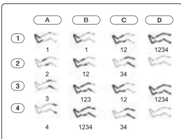
După pornirea aparatului, apăsarea repetată a butonului ON/OFF modifică zonele de masaj (1-2-3-4). Utilizați butonul MODE pentru a schimba modurile (A-B-C-D). Schema de conectare a modurilor și principiul funcționării acestora sunt prezentate în imaginea de mai sus. Folosind butonul TIMER, putem seta liber senzorul, după care dispozitivul se va opri automat. Butonul INTENSITATE modifică succesiv puterea și intensitatea masajului.
