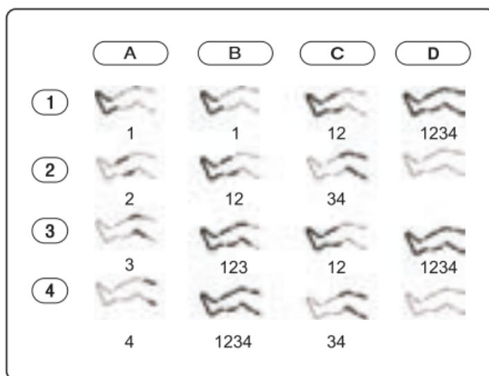
Dopo aver avviato il dispositivo, la pressione ripetuta del pulsante ON/OFF cambia le aree di massaggio (1-2-3-4). Utilizzare il pulsante MODE per cambiare modalità (A-B-C-D). Lo schema di collegamento delle modalità e il principio del loro funzionamento sono mostrati nell'immagine sopra. Utilizzando il pulsante TIMER, possiamo impostare liberamente il sensore dopodiché il dispositivo si spegnerà automaticamente. Il pulsante INTENSITY cambia successivamente la forza e l'intensità del massaggio.
