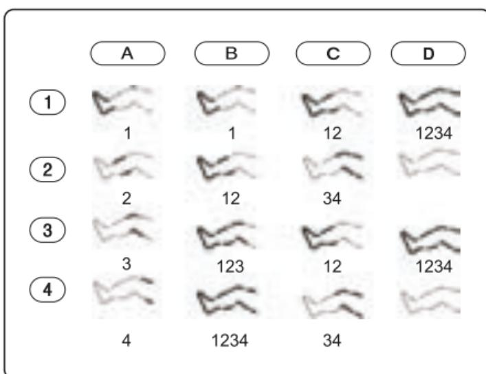
Después de encender el dispositivo, la presión repetida del botón ON/OFF cambia las áreas de masaje (1-2-3-4). Utilice el botón MODE para cambiar de modo (A-B-C-D). El diagrama de conexión de los modos y el principio de su funcionamiento se muestran en la imagen de arriba. Con el botón TIMER, podemos configurar libremente el sensor después del cual el dispositivo se apagará automáticamente. El botón INTENSIDAD cambia la fuerza y la intensidad del masaje sucesivamente.
