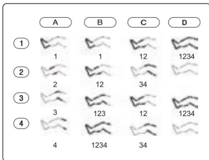
Depois de iniciar o aparelho, pressionando repetidamente o botão ON/OFF muda as áreas de massagem (1-2-3-4). Use o botão MODE para alterar os modos (A-B-C-D). O diagrama de conexão dos modos e o princípio de sua operação são mostrados na figura acima. Usando o botão TIMER, podemos definir livremente o sensor após o qual o dispositivo desligará automaticamente. O botão INTENSIDADE altera sucessivamente a força e a intensidade da massagem.
