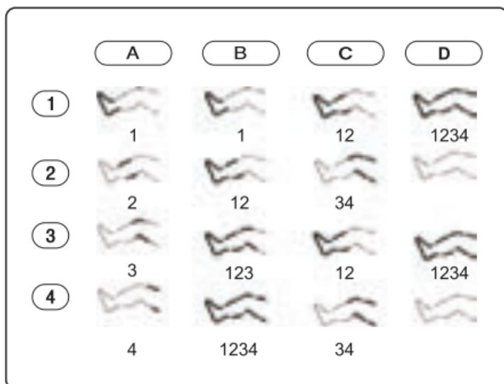
Kun laite on kytketty päälle, ON/OFF-painikkeen painaminen uudelleen ja uudelleen muuttaa hieronta-alueita (1-2-3-4). Käytä MODE-painiketta vaihtaaksesi tiloja (A-B-C-D). Tilojen kytkentäkaavio ja niiden toimintaperiaate näkyvät yllä olevassa kuvassa. TIMER-painikkeella voimme vapaasti asettaa anturin, minkä ajan kuluttua laite sammuu automaattisesti. INTENSITY-painike muuttaa hieronnan voimakkuutta ja intensiteettiä.
