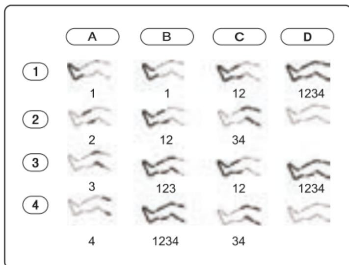
Nakon uključivanja uređaja ponovnim pritiskom na tipku ON/OFF mijenjate područja masaže (1-2-3-4). Koristite gumb NAČIN RADA za promjenu načina rada (A-B-C-D). Dijagram povezivanja načina i načelo njihovog rada prikazani su na gornjoj slici. Pomoću tipke TIMER možemo slobodno postaviti senzor nakon kojeg vremena će se uređaj automatski isključiti. Gumb INTENSITY mijenja jačinu i intenzitet masaže.
