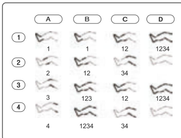
Etter å ha slått på enheten, trykk på PÅ/AV-knappen igjen og igjen endrer massasjeområdene (1-2-3-4). Bruk MODE-knappen for å endre modus (A-B-C-D). Tilkoblingsdiagrammet for modusene og prinsippet for deres drift er vist på bildet ovenfor. Ved å bruke TIMER-knappen kan vi fritt stille inn sensoren etter hvilken tid enheten slås av automatisk. INTENSITY-knappen endrer styrken og intensiteten til massasje.
